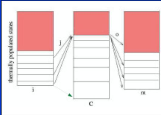
$$\frac{n_{\text{ex}}}{n_{\text{gs}}} = \frac{g_{\text{ex}}}{g_{\text{gs}}} e^{-\frac{E_x}{kT}}$$
